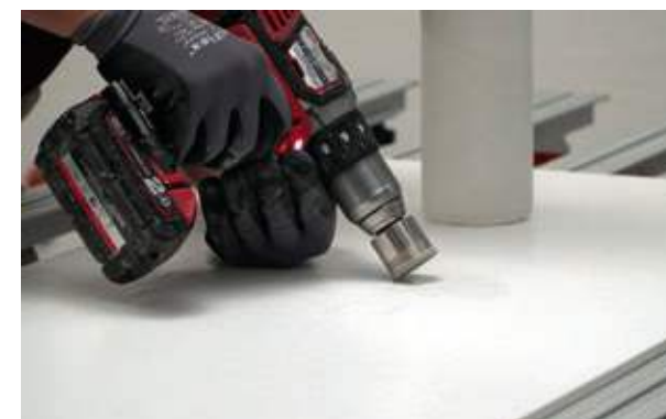
11. Lo si può forare in maniera semplice con risultati perfetti per qualsiasi esigenza di cantiere. 11. It can be drilled easily with optimal results to meet any construction site requirement. 11. Il peut être percé de façon simple avec des résultats parfaits quelles que soient les exigences du chantier. 11. Es kann auch auf einfache Weise mit perfekten Ergebnissen für jede Anforderung auf der Baustelle gebohrt werden. 11. Материал можно резать любым способом с отличными результатами.
